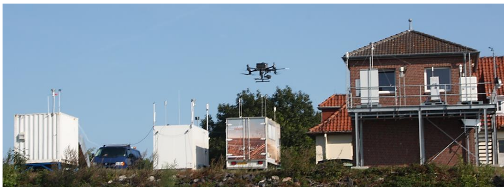
Les émissions maritimes ont été mesurées par : une station autonome permanente (surélevée par rapport au bâtiment) et par une nouvelle station mobile (le camion en blanc au centre) appartenant toutes deux à la German Federal Maritime and Hydrographic Agency, une autre station mobile (camion à droite) appartenant au Netherlands Research Centre for Applied Scientific Research et TNO, plusieurs systèmes de mesures de l'Université de Technologie de Chalmers en Suède (le camion et le container blanc) et par le drone du Danish Explicit ApS.
